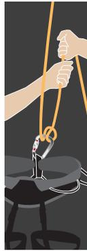
**HMS:** Beide Hände sind am Bremsseil. Das Ablassen erfolgt langsam und kontrolliert durch eine parallele Seileingabe von oben, indem die Hände entsprechend hin- und hergeschoben werden. Das Übergreifen beim Ablassen ist ebenfalls zulässig.
